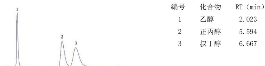
图A. 3 GDx-102柱血中酒精含量检测色谱图 (柱3)
